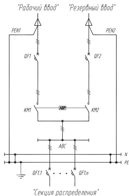
Схема электрическая однолинейная ВРУ-ID-XXX-03-11К
