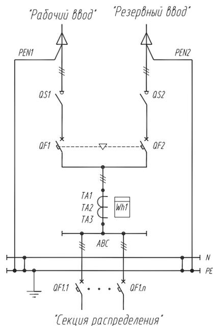
Схема электрическая однолинейная
