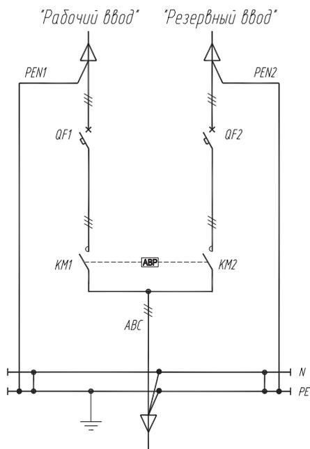
Схема электрическая однолинейная ВРУ-ID-XXX-01-11К
