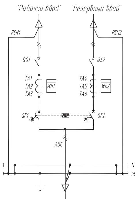
Схема электрическая однолинейная
