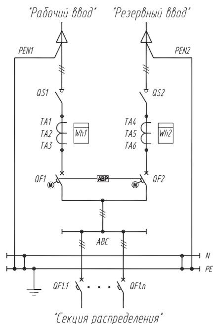
Схема электрическая однолинейная
