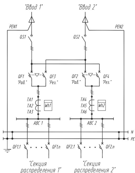
Схема электрическая однолинейная
