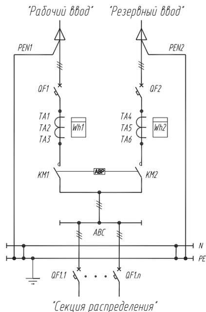
Схема электрическая однолинейная ВРУ-ИД-XXX-03-10К
