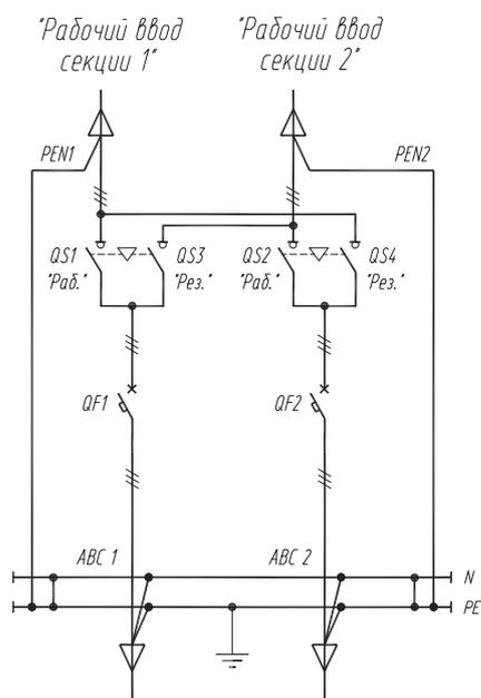
Схема электрическая однолинейная
