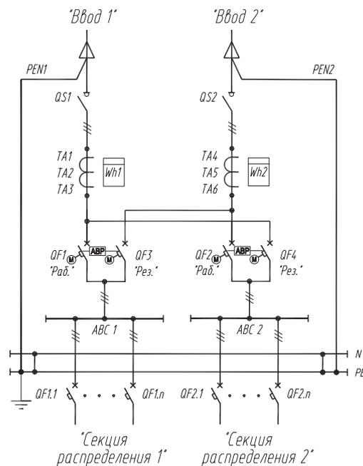
Схема электрическая однолинейная ВРУ-ID-XXX-03-12
