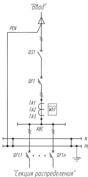
Схема электрическая однолинейная
