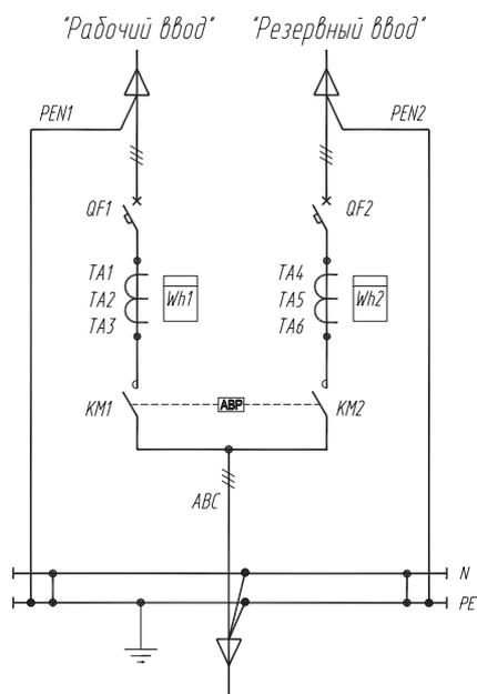
Схема электрическая однолинейная ВРУ-ID-XXX-01-10К
